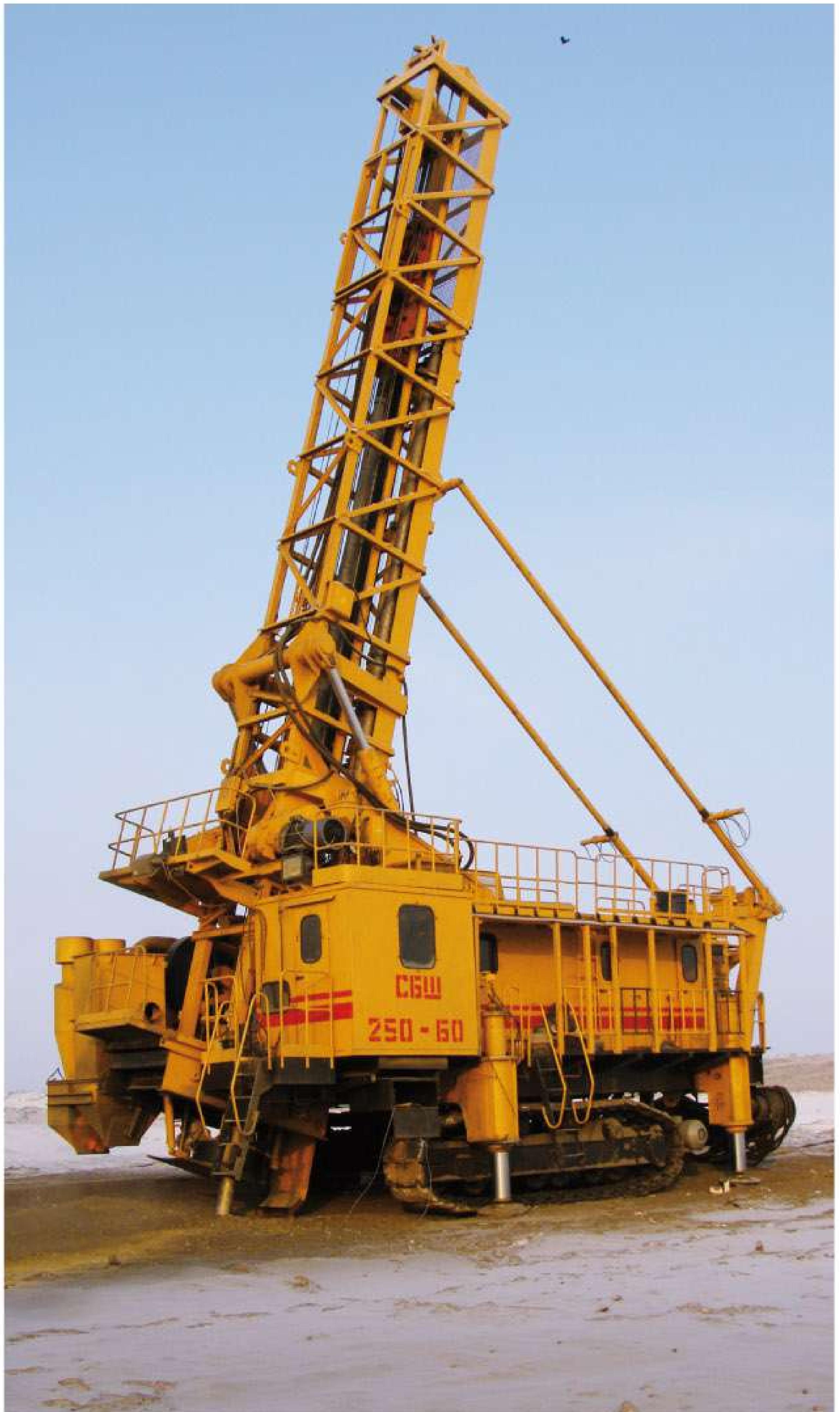
Станок создан для работы в сложных горно-геологических условиях с крепостью пород 6-20ед. по шкале проф. Протодьяконова и высокой абразивностью. Глубина бурения до 55 м.
