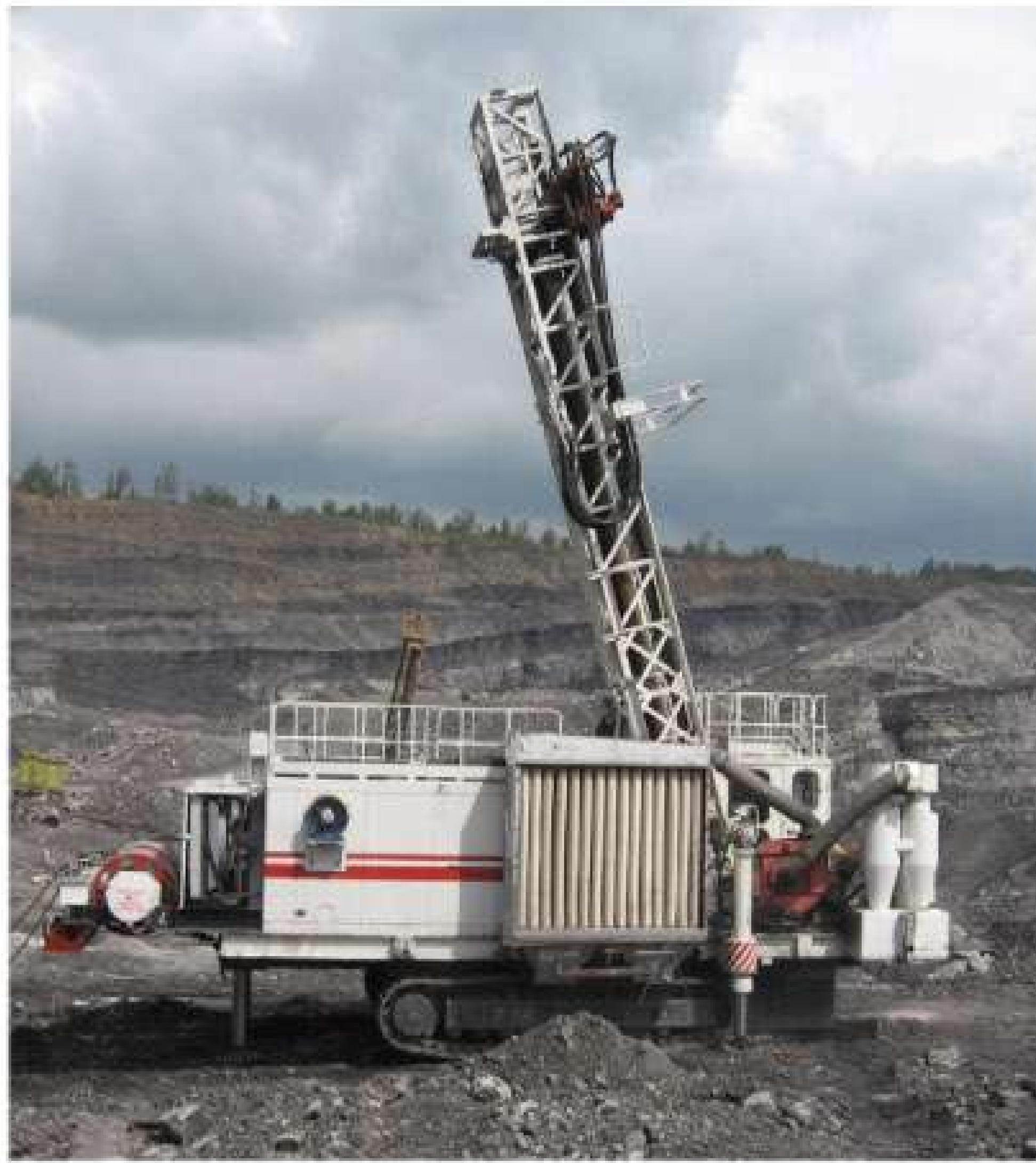
Гидрофицированный, с электрическим приводом, станок буровой шарошечного типа предназначен для бурения технологических взрывных скважин в породах крепостью  $f=6\ldots18$  ед. по шкале профф. Протодьяконова на открытых горных разработках полезных ископаемых, а также при выполнении работ по заоткоске уступов бортов карьеров по предельному контуру.
