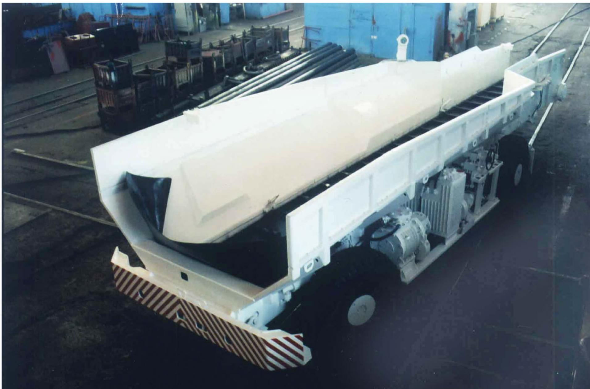
Предназначен для аккумуляции горной массы, добываемой комбайнами "Урал-20А", "Урал-20Р", и последующей перегрузки ее в самоходный вагон ВС-30 на калийных рудниках, опасных по газу (метану) и пыли. Бункер-перегрузатель выпускается в двух исполнениях: на напряжение 660В и 1140В; представляет собой бункер - кузов со встроенным в его днище двухцепным скребковым конвейером, установленный на четырёх пневмоколесах: два передних – поворотные, не ведущие; задние – приводные, не поворот-
