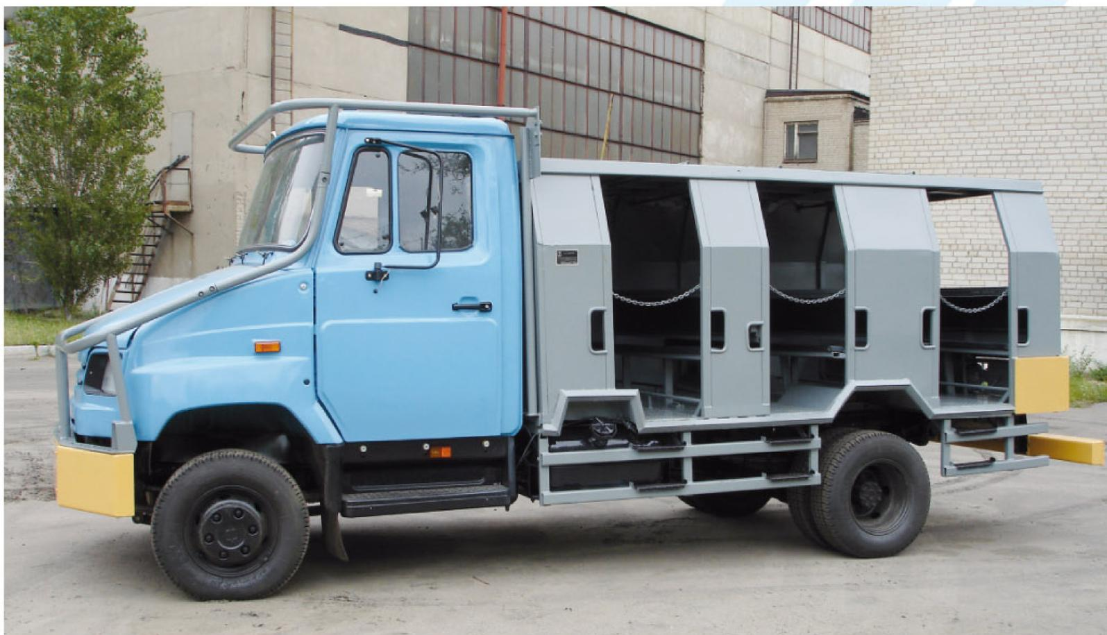
Машина транспортная выполнена на базе автомобиля ЗИЛ – 5301 В2, предназначена для перевозки людей в подземных условиях рудников и угольных шахт, не опасных по газу и пыли. The transportation machine is based on the type of automobile ЗИЛ – 5301 В2. It is designed for hauling men in underground conditions of mines not dangerous in gas and dust content.
