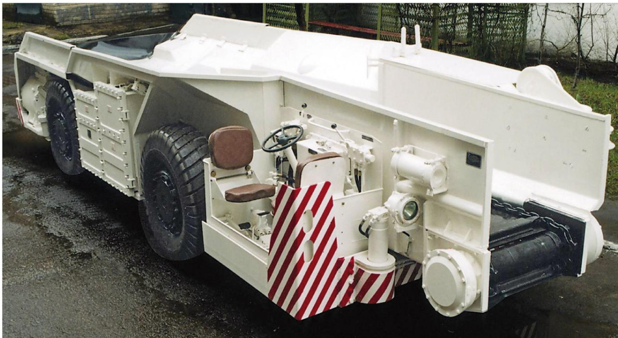
ВАГОН ШАХТНЫЙ САМОХОДНЫЙ 10BC 15 • SELF-PROPELLED MINE CAR 10BC 15
